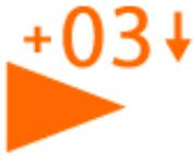
Großer orangefarbener Pfeil: Es besteht Kollisionsgefahr mit diesem Flugzeug. Es wird die Flugrichtung und Höhendifferenz in 100ft angegeben sowie Information über Steigen und Sinken des „Gegners“ gegeben. In diesem Beispiel: 300ft höher, sinkt, fliegt von links nach rechts.
