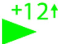
Großer Pfeil mit Höhenangabe: Der Große Pfeil gibt immer das nächste Flugzeug sowie dessen relative Höhe in 100 ft Schritten sowie Informationen über Steigen oder Fallen als Pfeil an. Der Pfeil symbolisiert die Flugrichtung des Flugzeuges über Grund. Beispiel: 2300ft tiefer, fliegt von links nach rechts und steigt.
