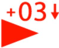
Sehr großer roter Pfeil: Es besteht unmittelbare Kollisionsgefahr. Zusätzlich wird der vertikale Winkel zum „Gegner“ angegeben. Es wird die Flugrichtung und Höhendifferenz in 100ft angegeben sowie Information über Steigen und Sinken des „Gegners“ gegeben. In diesem Beispiel: 300ft höher, sinkt, fliegt von links nach rechts.
